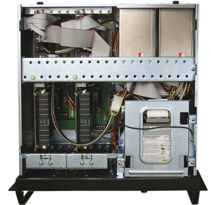
GO-4X2 Vista dall'alto senza copertura superiore
