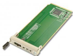
UTC008 μTCA JTAG Switch Module (JSM)
